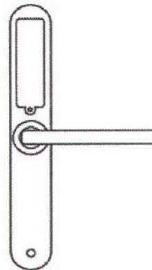
3. После регулировки направления рукоятки. Вставьте ее в гнездо рукоятки и снова зафиксируйте шестигранный винт.
