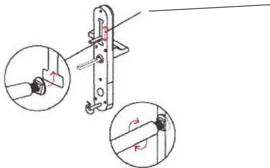
Место корпуса винта регулируется от 60 мм до 100 мм от квадратного вала. В зависимости от места сверления отверстия или старого дверного отверстия..17:49
