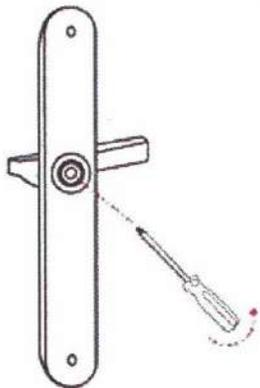
1. Поверните ручку на задней панели. Ослабьте внутренний шестигранный винт ручки против часовой стрелки
