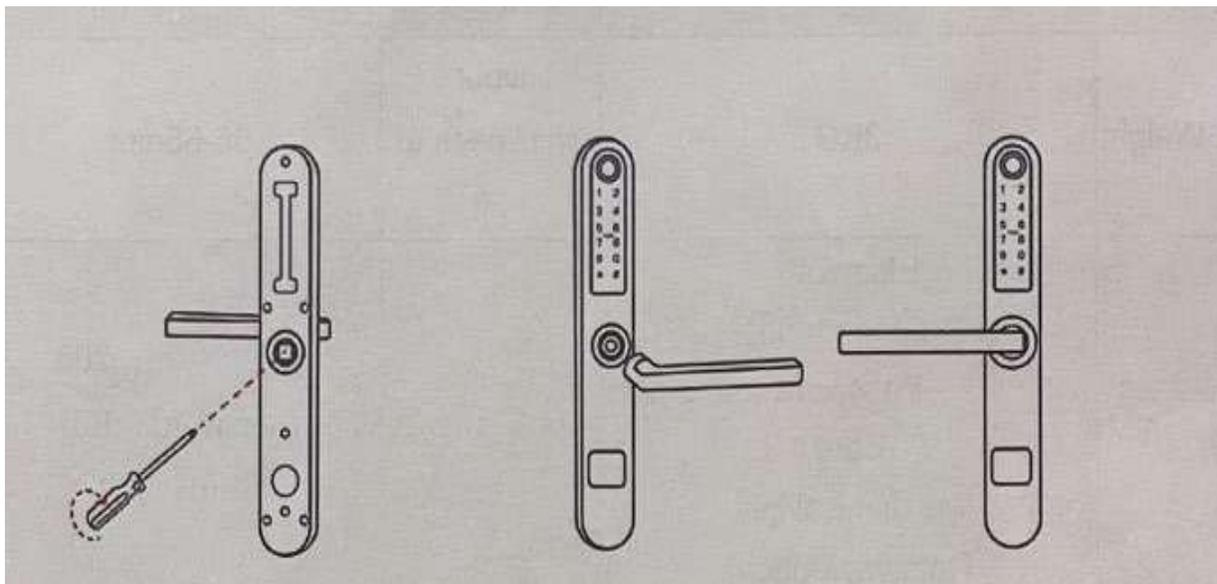
1. Поверните ручку на передней панели. Ослабьте внутренний шестигранный винт ручки против часовой стрелки
